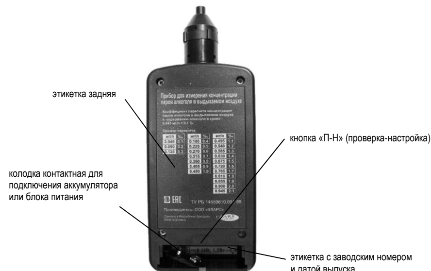
Рис.2. Вид прибора «АЛКОТЕСТ-203» сзади со снятой крышкой отсека питания.
