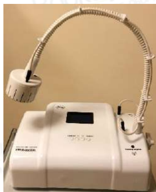
Рисунок 5 Крепление кабеля соединительного на электрододержателе
