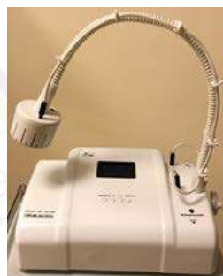
Рисунок 12 Установка индуктора на электрододержатель.
