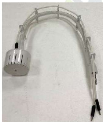
Рисунок 5 Крепление кабеля соединительного на электрододержателе
