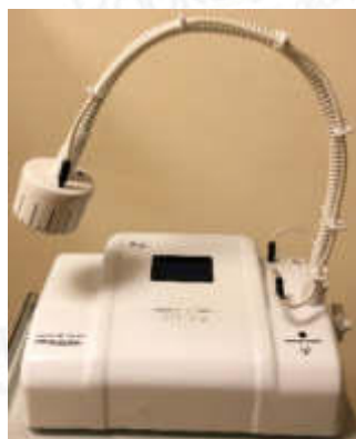
Рисунок 5 Крепление кабеля соединительного на электрододержателе
