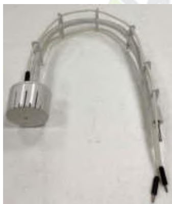
Рисунок 5 Крепление кабеля соединительного на электрододержателе
