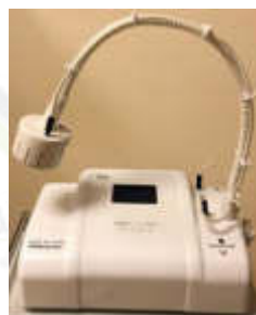
Рисунок 12 Установка индуктора на электрододержатель.
